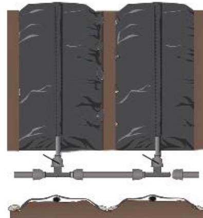
Vista dall'alto e in sezione dell'impianto di irrigazione del telo pacciamate
